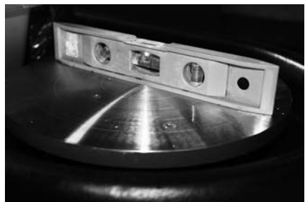
Фото 6 – фото 7. Регулировка горизонтальности планшайбы.
