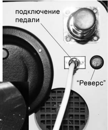
Фото 2. Подключение штекера педали и переключатель “Реверс” (вид снизу).
